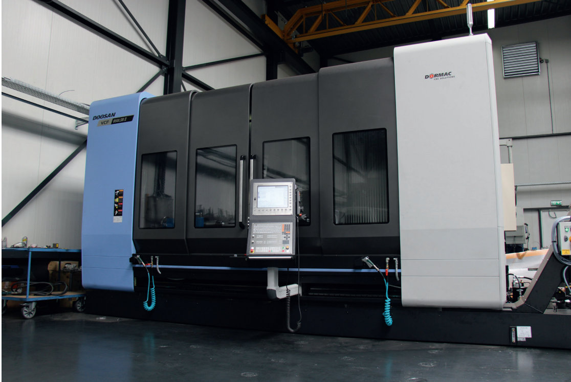
De vijfassige VCF 850 pendelfreesmachine werd kort voor de twee nieuwe verticale Puma V8300 M draaibanken in gebruik genomen
